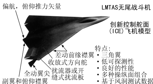
图 12 飞翼布局飞机的多种控制舵面
