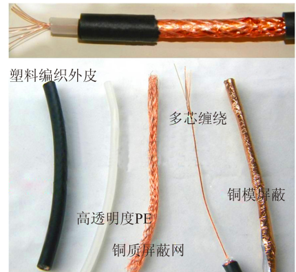
图 2 同轴电缆屏蔽线解剖图
