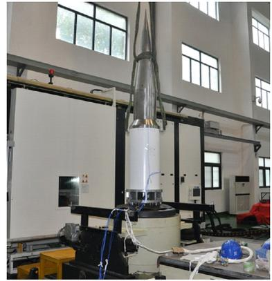
图 15 试验模型振动试验
