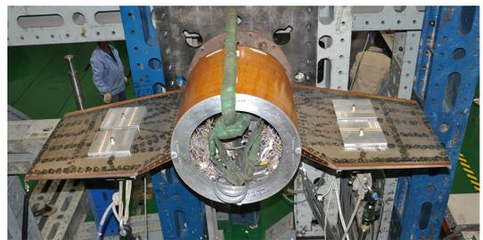
图13 尾翼/尾段静力试验
