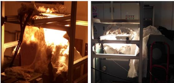
图 14 竖直与水平振动方向热振联合试验
