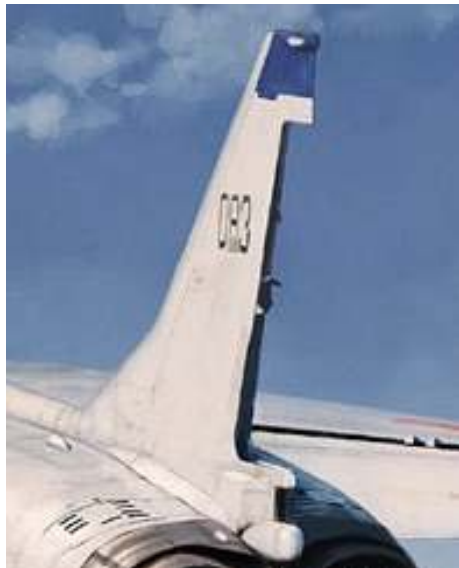
图 1 嗡鸣导致某飞机方向舵损毁 [7] Fig. 1 Buzz caused damage to the rudder [7]
