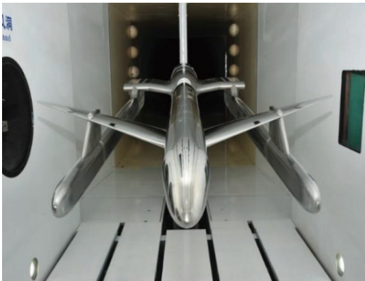
图 10 翼尖双支撑方式 [20]
