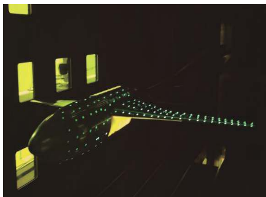
(a) CACM 标模机翼变形荧光标记点布置效果
