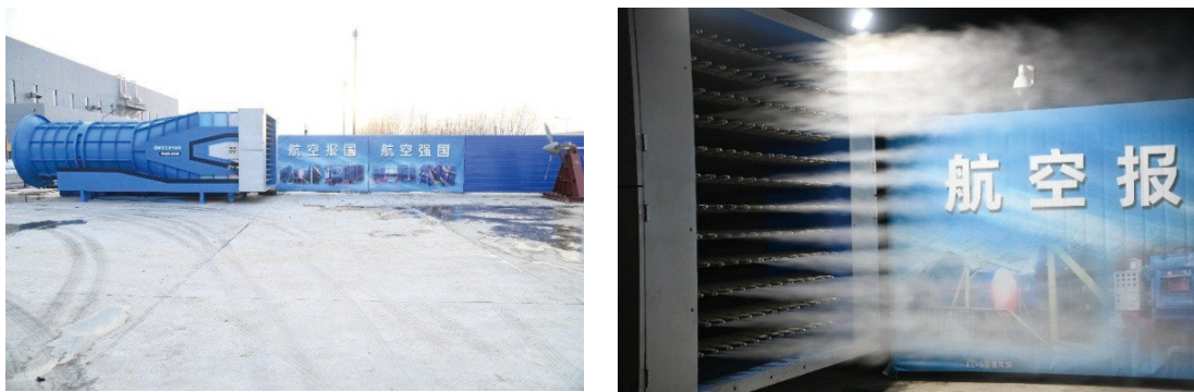
图 20 航空工业气动院移动式冰风洞 [28]
