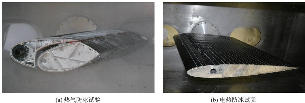
图 19 FL-61 风洞中开展的热气防冰试验与电热防冰试验 [27]
