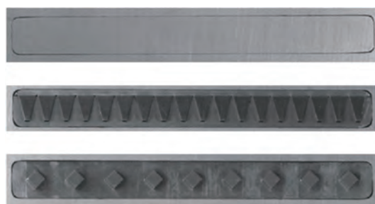
图11 X-51风洞试验研究的三种前体迎面锯齿 [66]
